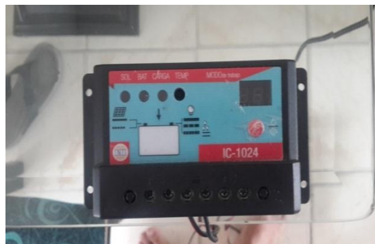
Figura 16. Controlador de Carga INTI .Imagen tomada: propia. Fecha de actualización: 31 de mayo de 2015
